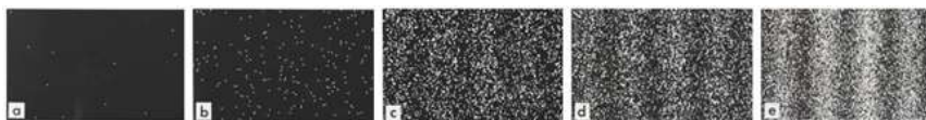
L'esperimento della doppia fenditura con gli elettroni: a) 10 elettroni; b) 100; c) 3.000; d) 20.000; e) 70.000 elettroni.
